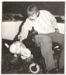
An manche Rollstuhlmodelle läßt sich problemlos ein Babysitz anbringen. Dazu wird am Boden eines normalen Kindersitzes eine kurze Stange befestigt. Diese wird dann in eine Buchse gesteckt, die vorher an einer Seite des Rollstuhles angeschraubt oder geklemmt wurde. Ein solcher Sitz kann einerseits zum Transport des Kindes für drinnen und draußen und aufgrund seiner Beweglichkeit auch zum Füttern benutzt werden.
